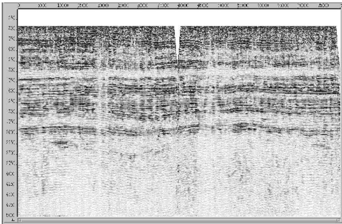
Рис. 5. Разрез, полученный после вычитания поля кратных волн.
