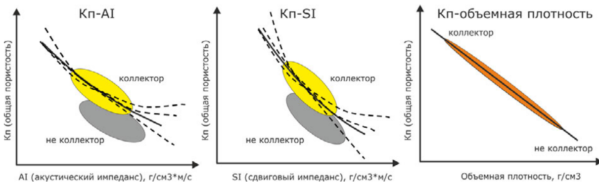
Рис. 2.3. Пример сопоставления акустического (AI), сдвигового (SI) импедансов и объемной плотности с общей пористостью горной породы
