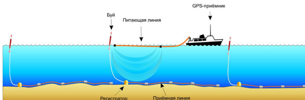
Рисунок 4.5. Общая схема выполнения измерения (работы 2008 г. в Сев. Каспии).
