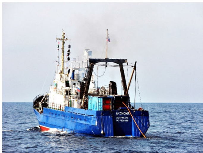
Рисунок 2.5. Судно-источник буксирует генераторную линию (Чёрное море, 2011 г.).
