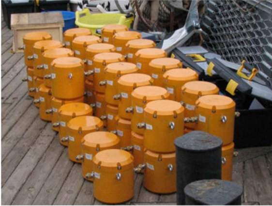
Рисунок 4.7. Внешний вид кабельных систем. А) Регистраторы в прочных корпусах Б) Приёмные линии с электродами.
