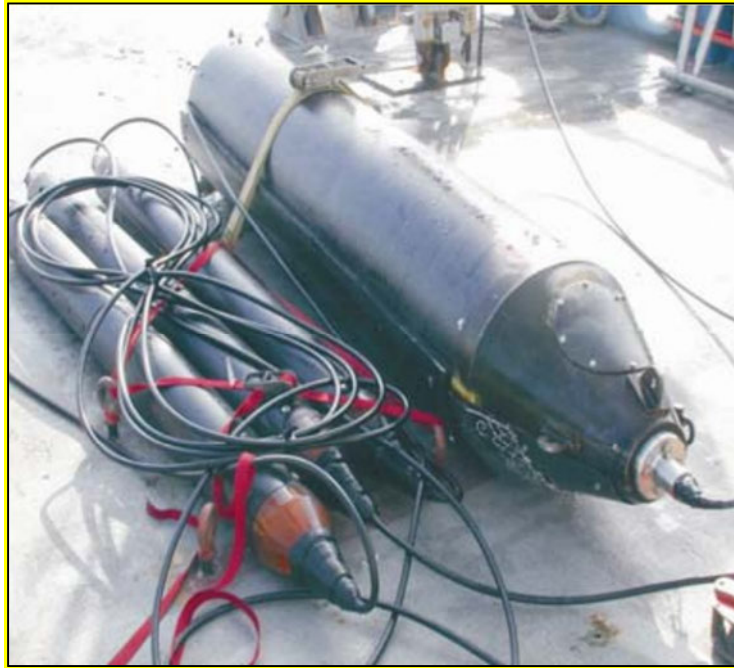
Рисунок 1.12. Фотография буксируемой установки с горизонтальным магнитным диполем из работы (Evans, 2007).
