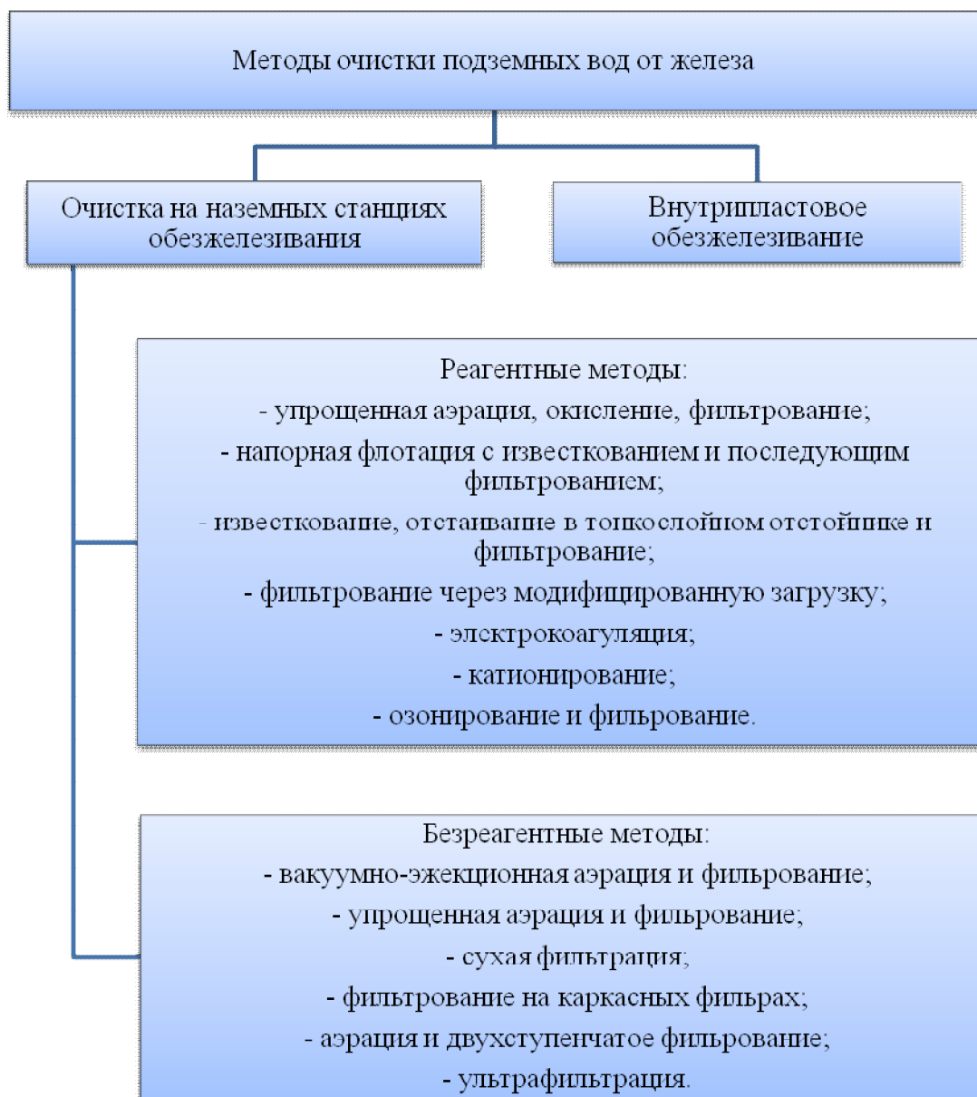
Рис. 5. Методы очистки подземных вод от железа (по данным [22])
